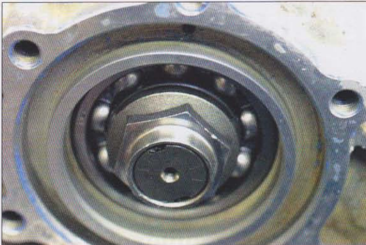
Obr. 4 – Speciální matice zajišťující kola na hřídeli
