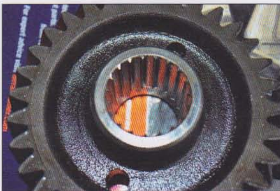
Kolo s poškozeným vnitřním drážkováním
