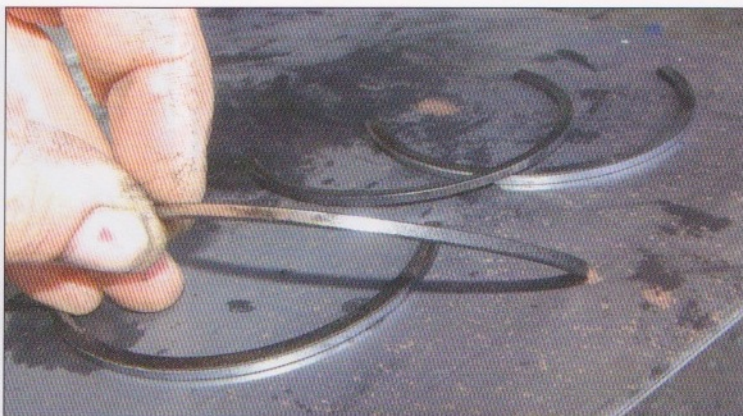
Zaleštěná rez na prasklém kroužku (12H-T)
