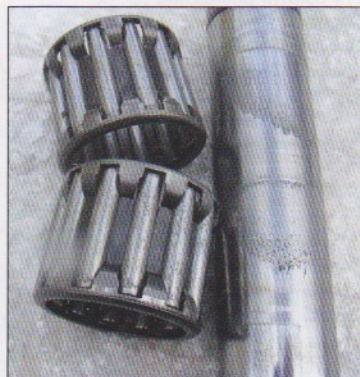
Obr. 1c – Opatřebená (vymačkaná) hřídel s ložisky
